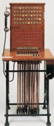
Comutador Telefónico Siemens, OB2600, início do Séc. XX
