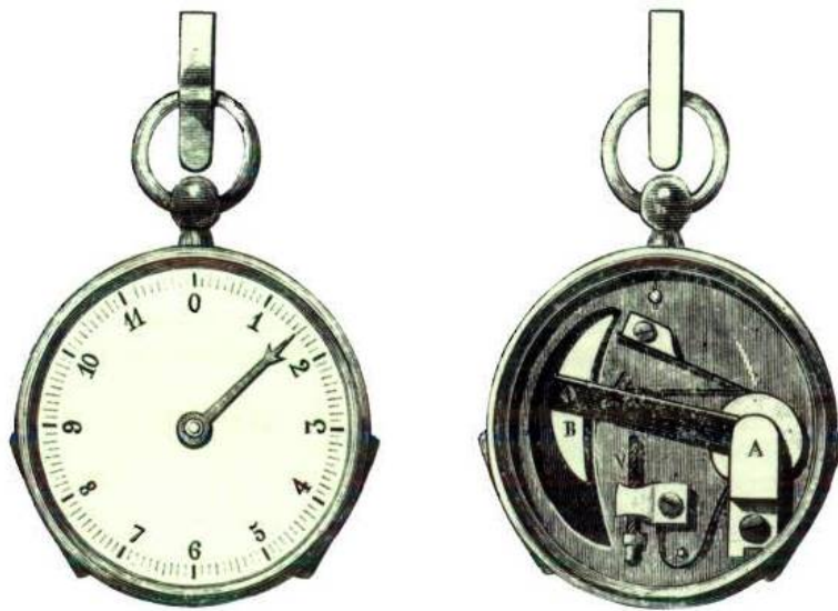
Figura 25 – Podómetro (interior e exterior): aparelho que se amarrava numa perna do distribuidor; contava o número de passos e por estimativa a distância percorrida. Era também usado no Exército.
