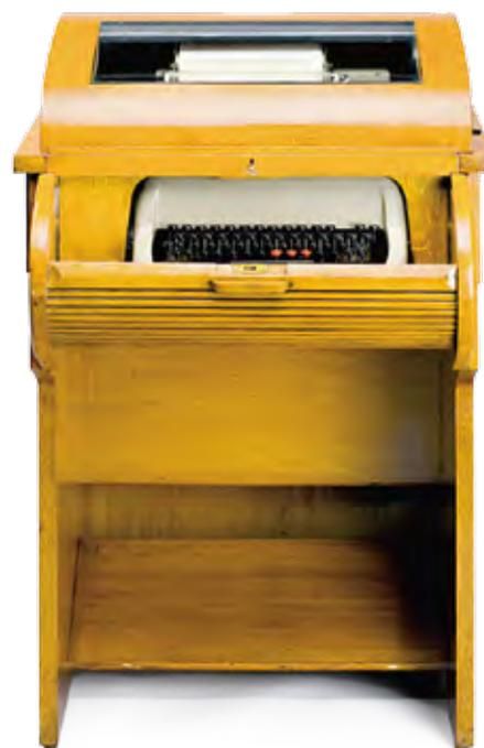
Teleimpressor Olivetti em móvel abafador de ruído.
